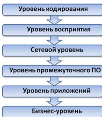
Рисунок 1. Шестиуровневая архитектура IoT
