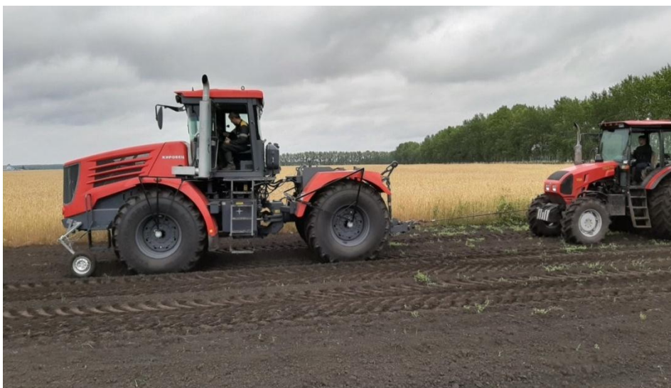
Рисунок - Определения силы сопротивления перекачиванию и тягового баланса трактора
