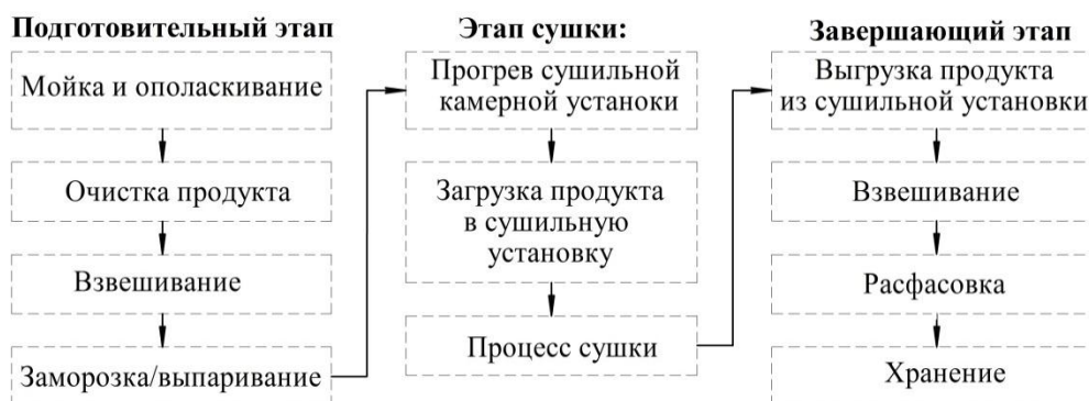
Рисунок 2 – Технологическая схема производства сухого сока
