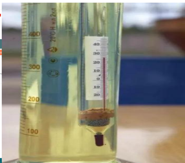
Рисунок 2 – Визуализация измерения плотности нефтепродукта с одновременным измерением температуры [4]
