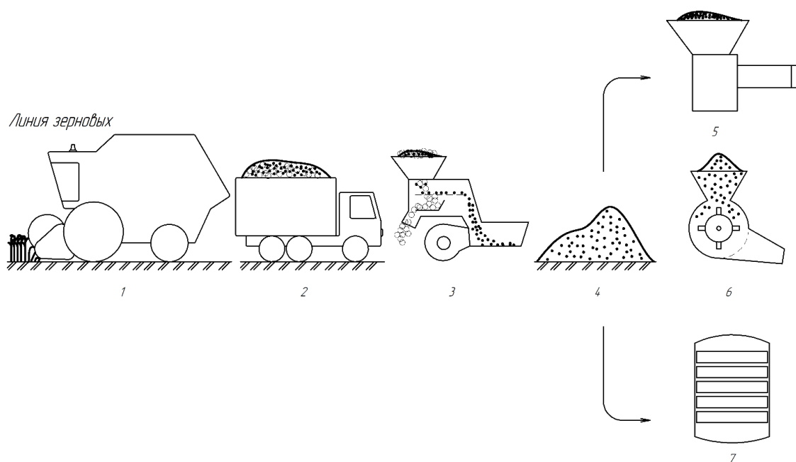
Рисунок 5 – Технология заготовки концентрированных кормов: 1 - уборка хлебной массы, обмолот, загрузка в транспортные средства; 2 - транспортировка зерна; 3 - очистка, сушка; 4- хранение; 5 - экструдирование зерна; 6 - измельчение зерна; 7- проращивание зерна.
