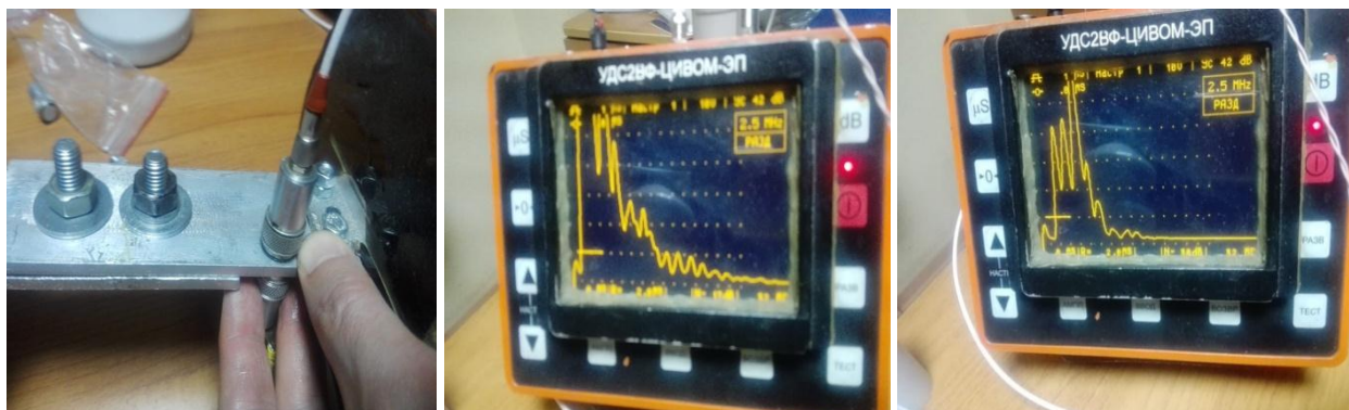
Рисунок 1.- Демонстрация процесса экспериментальных работ по использованию ультразвука для определения технического состояния элементов распределительной сети.
