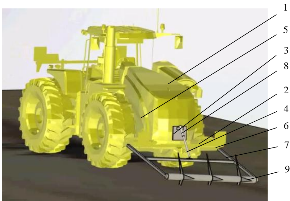
Рисунок 1 - Профильный вид колёсного полурамного трактора с установленным фронтальным прокальвателем-щелерезом: 1-трактор; 2-передний бампер трактора; 3-кронштейн гидроцилиндра; 4-нагружающий гидроцилиндр; 5- передняя полурама трактора; 6-установочный кронштейн прокальвателя; 7-продольная тяга рамы прокальвателя; 8- поперечная тяга рамы прокальвателя; 9-подшипниковый узел с лучеобразными прокальвающими рабочими органами
