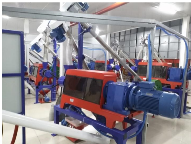
Рисунок 2 – Линия получения растительного масла (НПП «А-ИНЖИНИРИНГ», г. Новосибирск, Россия [11])
