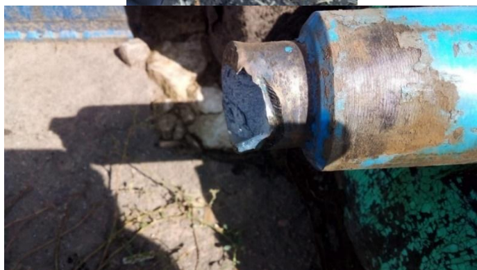
Рисунок 1 – Поломки оборотных плугов PERESVET
