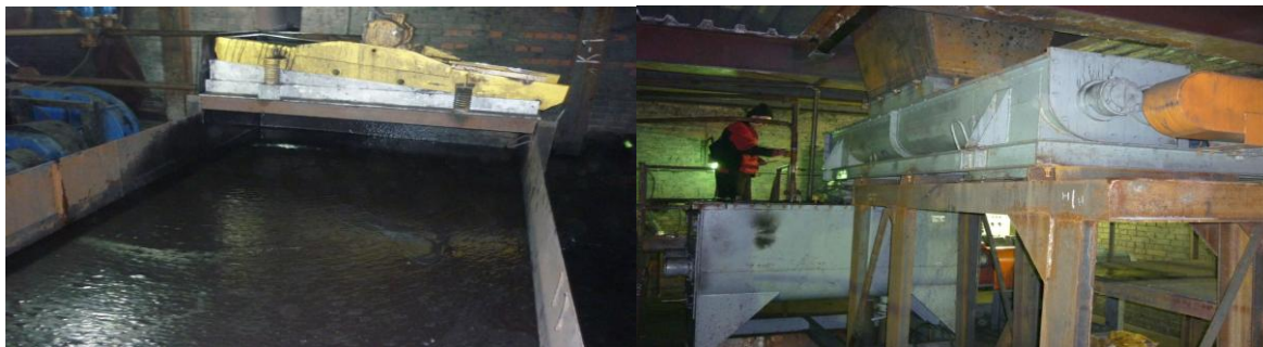
Рисунок 1 – а - зумпф с ВУС, б - питатель и смеситель.
