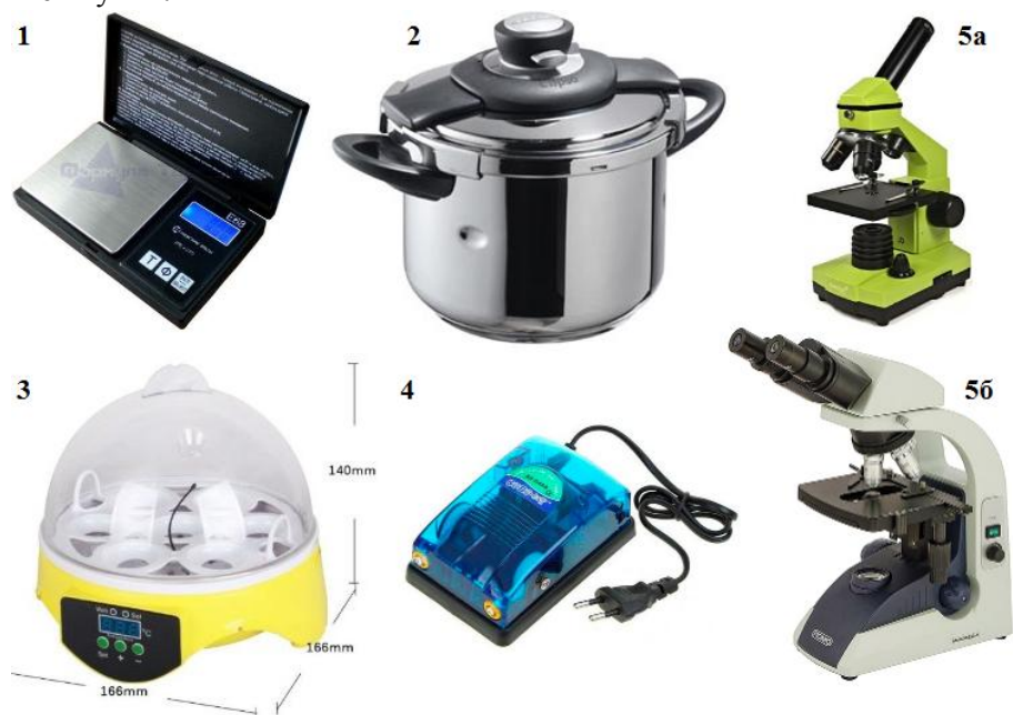
Рисунок 1 – Наиболее важное оборудование для самодельной дешёвой микробиологической мини-лаборатории: 1 – весы карманные, 2 – скороварка, 3 – мини-инкубатор, 4 – аквариумный компрессор, 5а – микроскоп в "минимальном" варианте, 5б – микроскоп в "бюджетном" варианте (см. табл. 1, 2)
