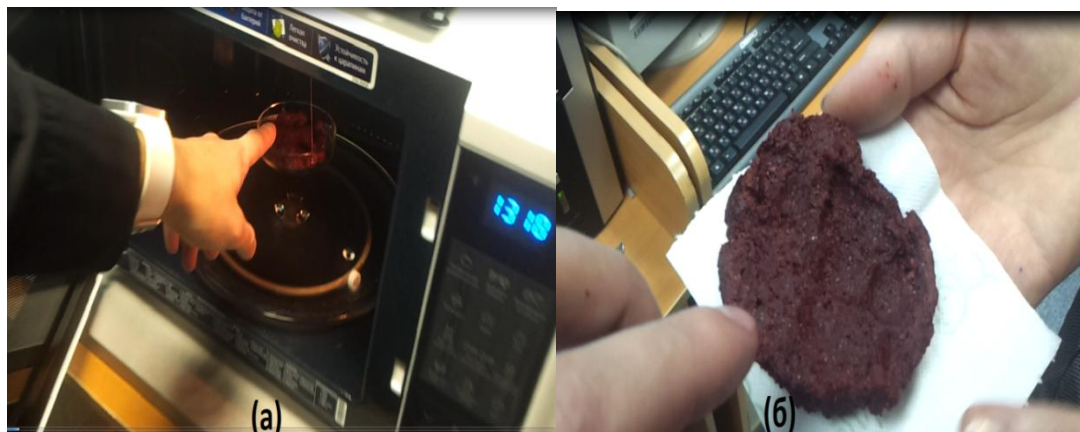
Рисунок 2 – Установка жмыха в рабочую камеру лабораторной установки (а) и внешний вид высушенного материала (б).
