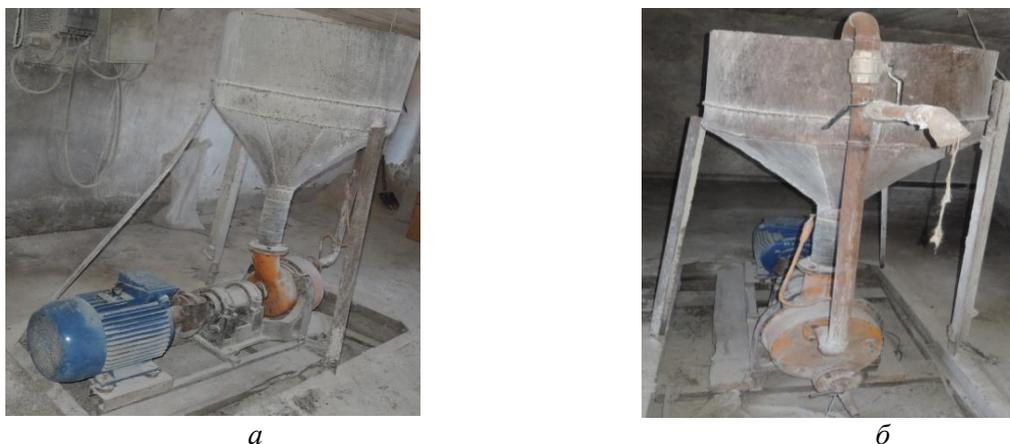
Рисунок 1. Общий вид кавитационной установки: а – вид сбоку; б – вид спереди
