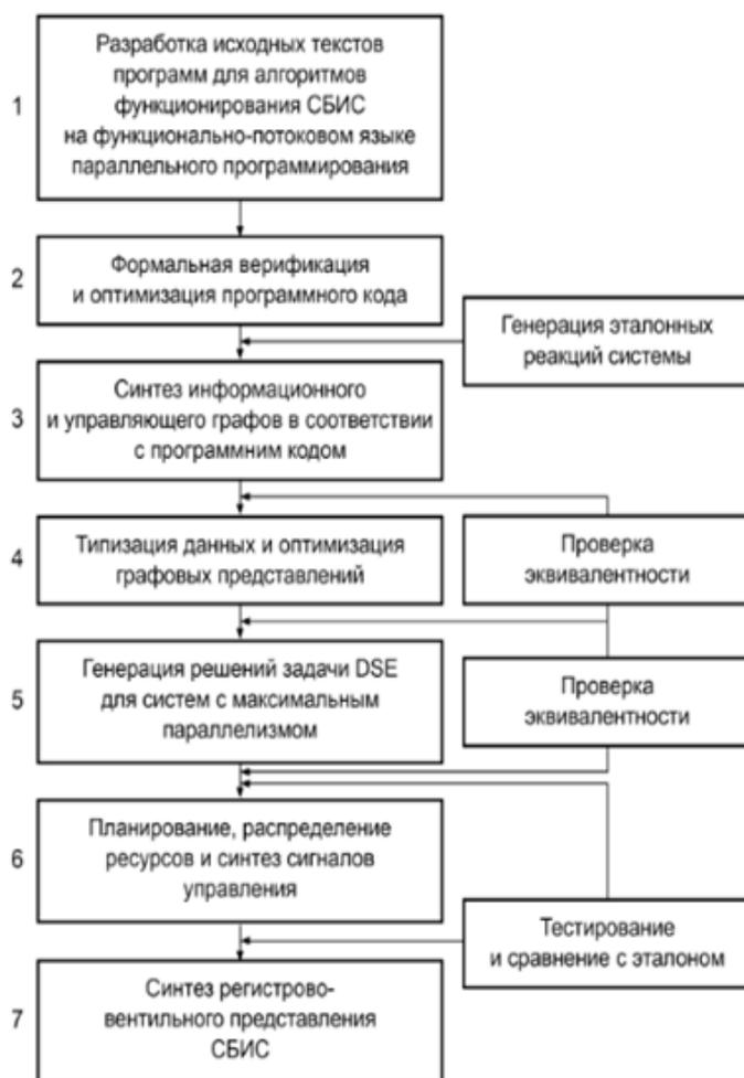
Рисунок 1 Функционально-поточковая технология синтеза
