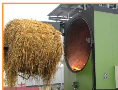
Рисунок. Газогенераторный котел HERLT HSV 1000
