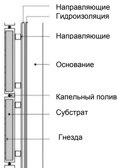
Рис. 2 – Схема модульной системы озеленения
