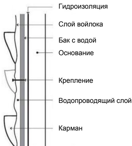
Рис. 1 – Схема войлочной системы озеленения
