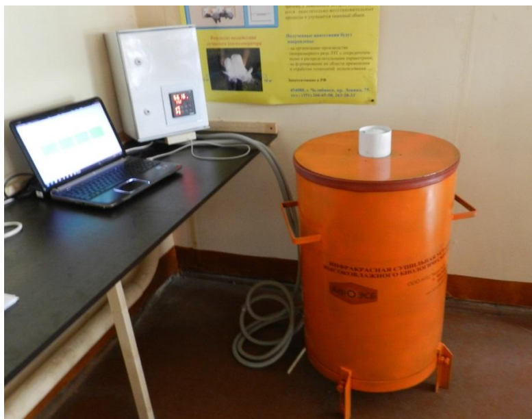
Рисунок 3 – Внешний вид системы автоматического управления и регулирования процесса сушки
