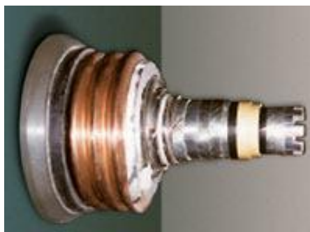
Рисунок 1 - Низкотемпературный сверхпроводниковый силовой кабель на 3 ГВА [2]
