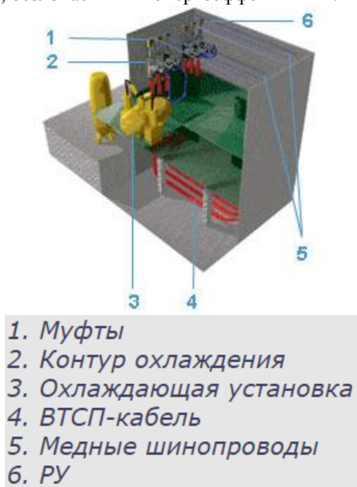
Рисунок 3 - Схематичный разрез подстанции АМК, Копенгаген[1]
