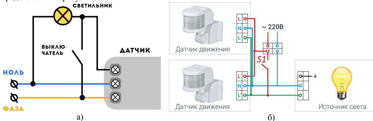
Рисунок 3. Схемы включения датчиков присутствия в электрическую сеть освещения. а – типовое включение датчика в сеть; б – включение в осветительную сеть двух датчиков для расширения рабочей зоны сенсоров.
