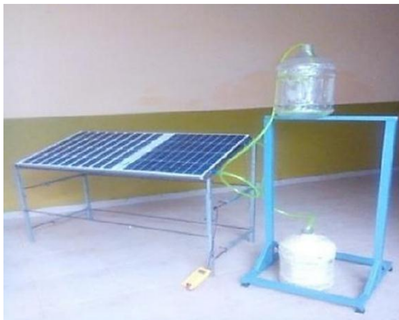
Рисунок 2 – Система пассивного водяного охлаждения
