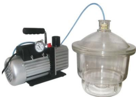
Рисунок 1. Основные элементы лабораторной портативной установки для вакуум-сушки
