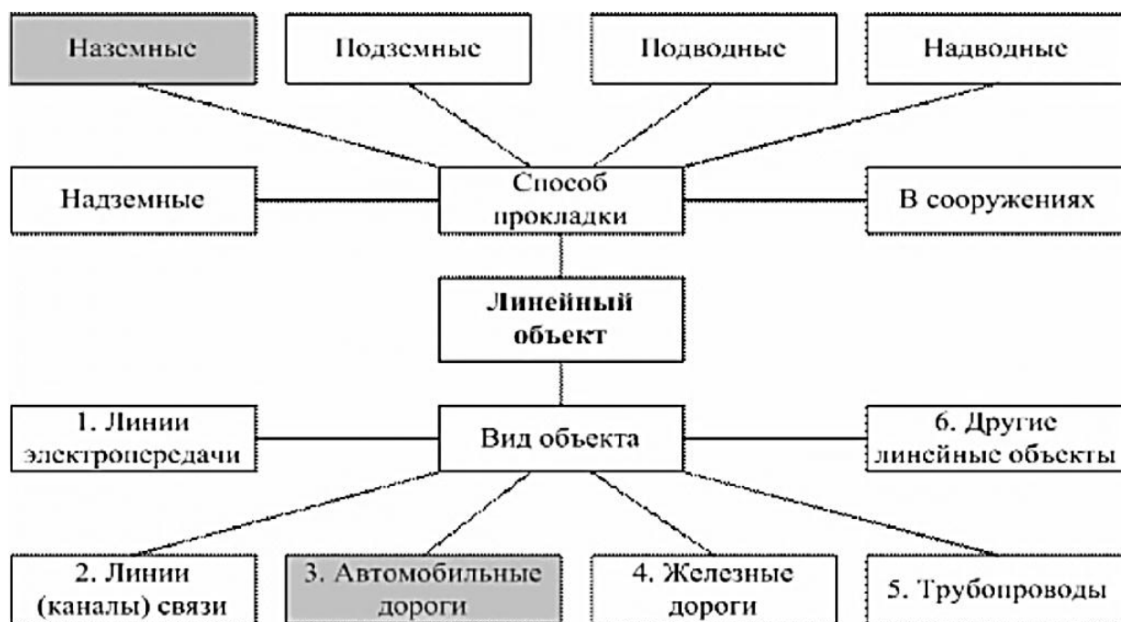
Рисунок 1 – Виды линейных объектов и способы их прокладки [5]
