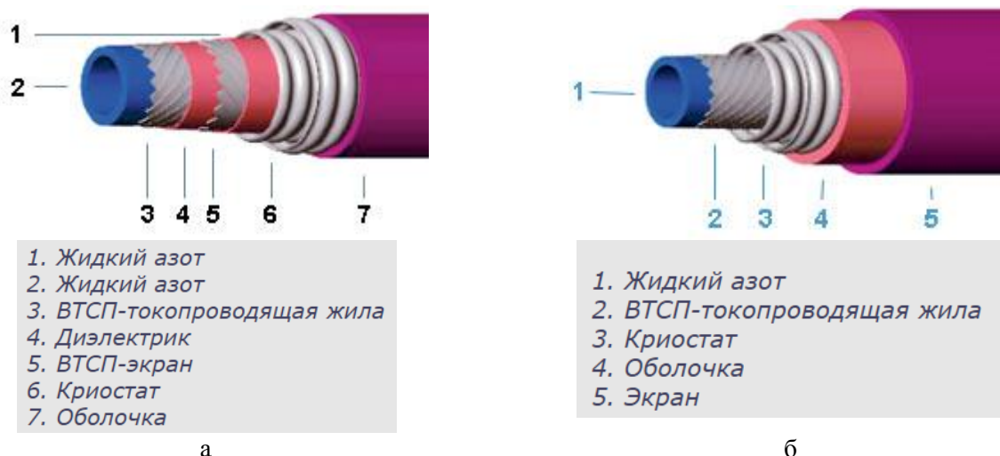
Рисунок 2 - Конструкция высокотемпературного сверхпроводникового кабеля: а) с холодным диэлектриком; б) с теплым диэлектриком [1]
