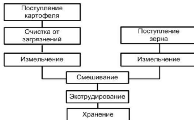
Рисунок 1 – Схема получения экструдата
