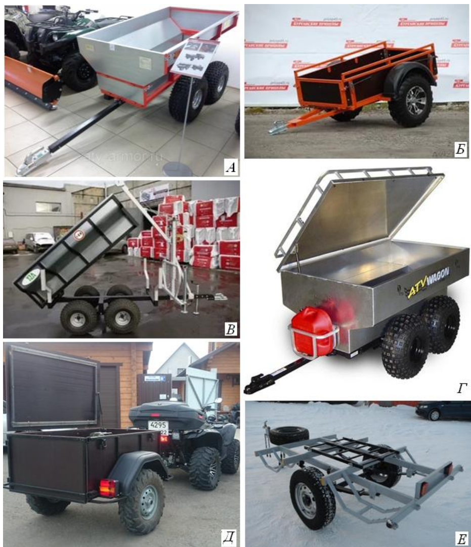
Рисунок 1 – Типы прицепов для внедорожных мототранспортных средств
