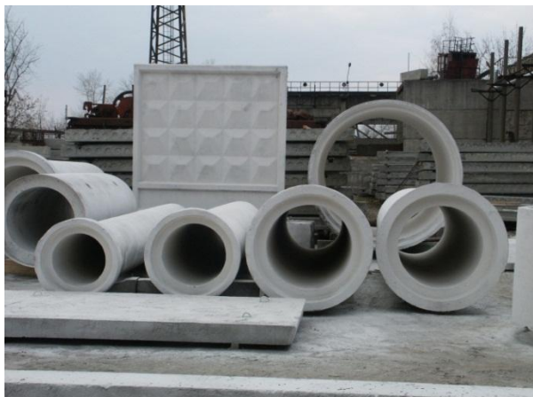
Рисунок 1 – Железобетонные трубы различных диаметров для мелиорации
