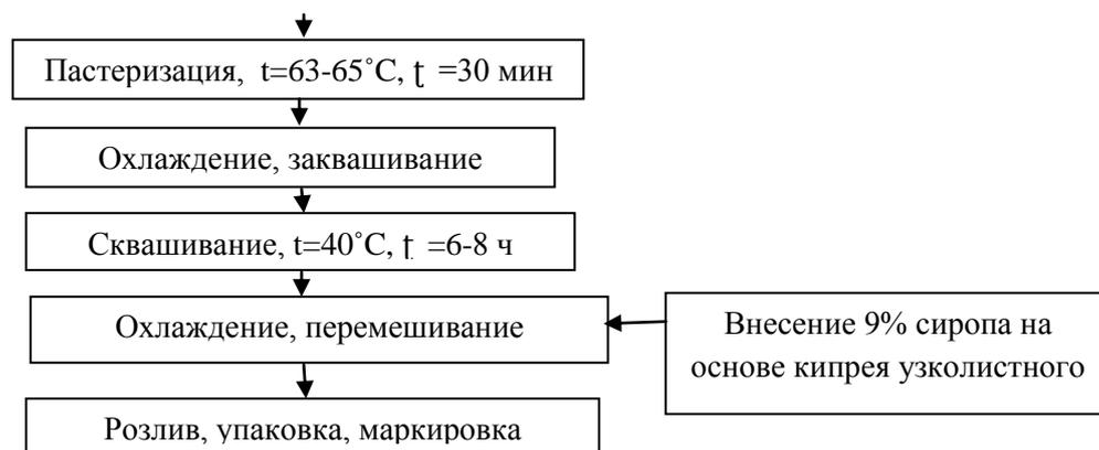
Рисунок 1 – Технологическая схема производства йогурта с внесением сиропа на основе кипрея
