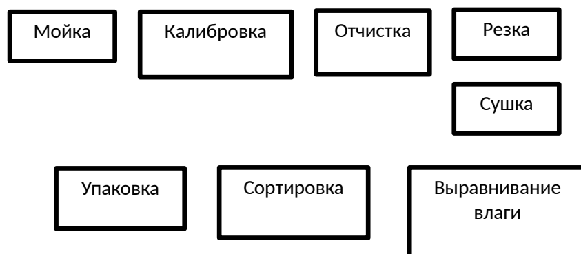
Рисунок 1 - Технологическая схема сушки грибов
