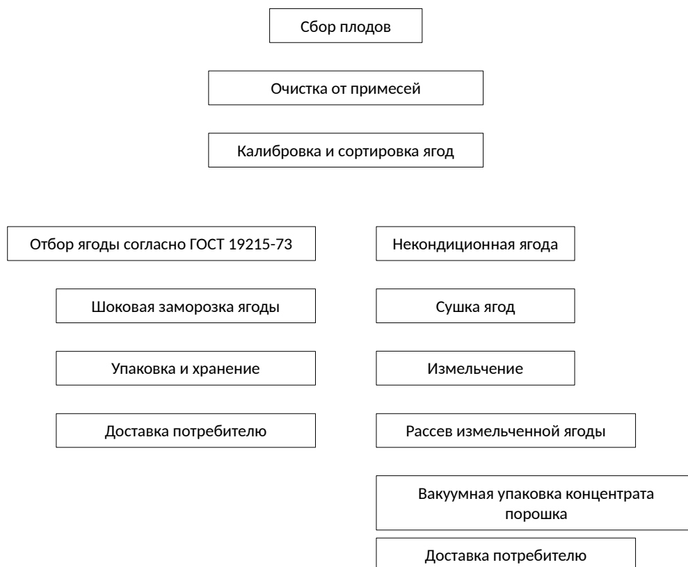
Рисунок 1 - Технологическая схема комплексной переработки клюквы
