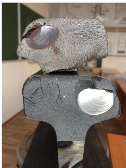
Рис. 2. Излом рельса, вызванный наличием флокена
