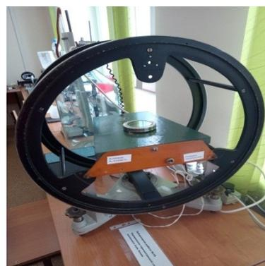
Рисунок 3. Лабораторная установка для измерения горизонтальной составляющей магнитного поля Земли.
