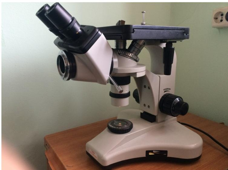
Рис. 1. Металлографический микроскоп ЛабоМет-1
