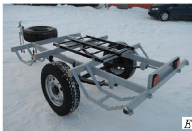
Рисунок 1. – Типы прицепов для внедорожных мототранспортных средств
