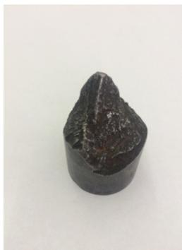
Рис. 1. Излом цапфы выгрузного шнека зерноуборочного комбайна
