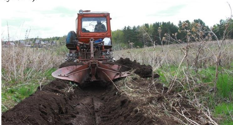
Рисунок 1 – Прокладка минерализованной полосы плугом ПКЛ-70
