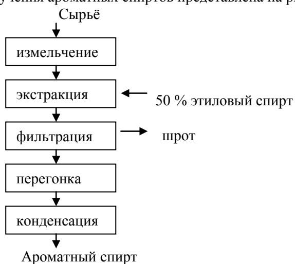
Рисунок 1 - Принципиальная схема получения ароматного спирта
