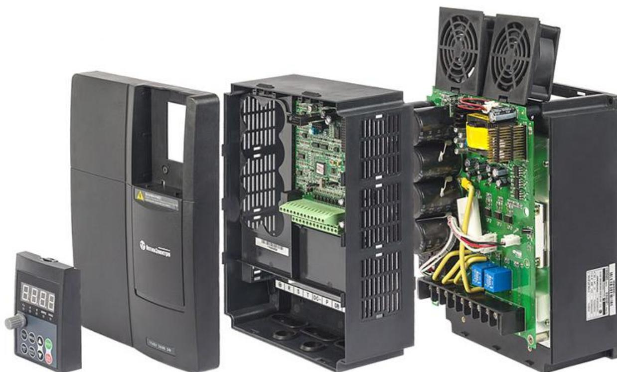
Рисунок 1. Частотный регулятор компании ООО «ОптимЭлектро» серии С100.
