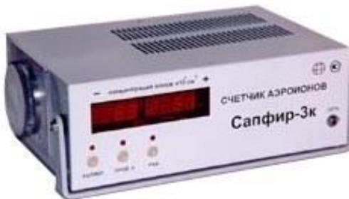
Рисунок 1- Счетчик аэроионов «Сапфир-3К»
