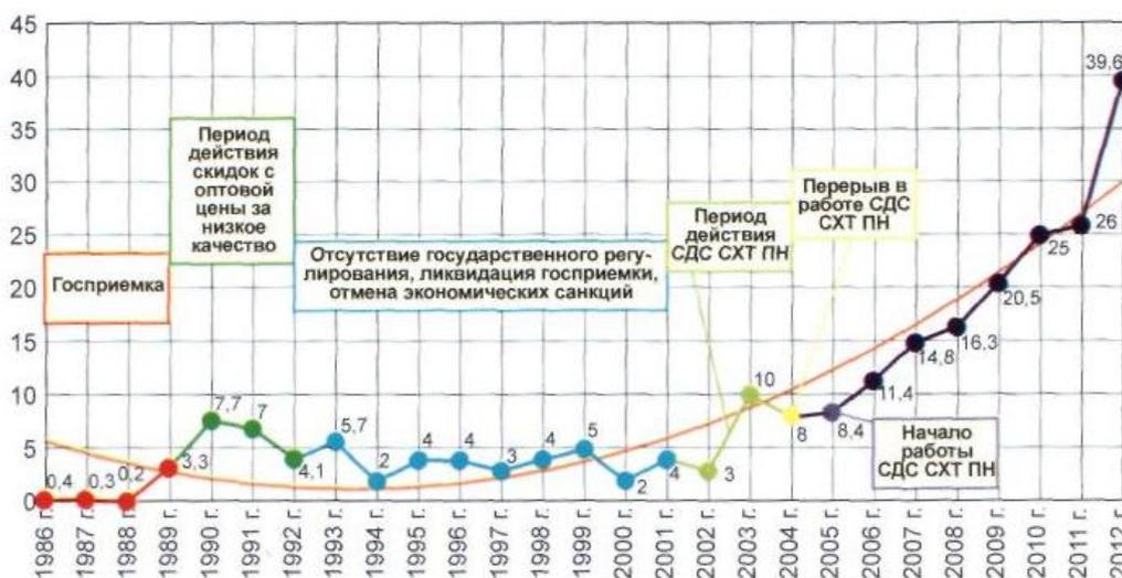
Рисунок 1- Количество техники отечественного производства, не имеющей отклонений от требований ТУ (от общего количества испытанных машин), %
