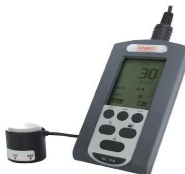
Рисунок 5 - Пиранометр KIMO SL 100
