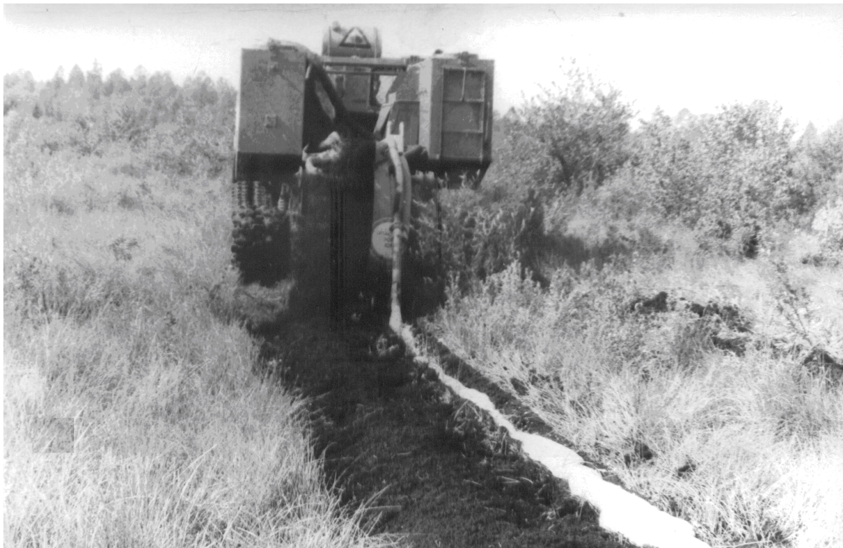
Рисунок 4 – Прокладка заградительного барьера из огнестойкой пены орудием ОЗТ-0,9 на тракторе ТЛП-4
