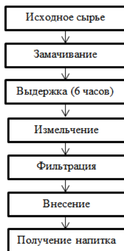
Рисунок 2 – Технология производства растительного напитка
