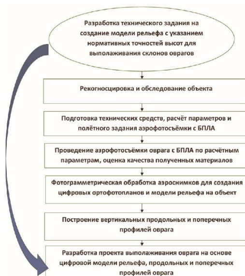
Рис. 1 Блок-схема технологии моделирования рельефа по снимкам, полученным с БПЛА, для выполаживания склонов оврагов
