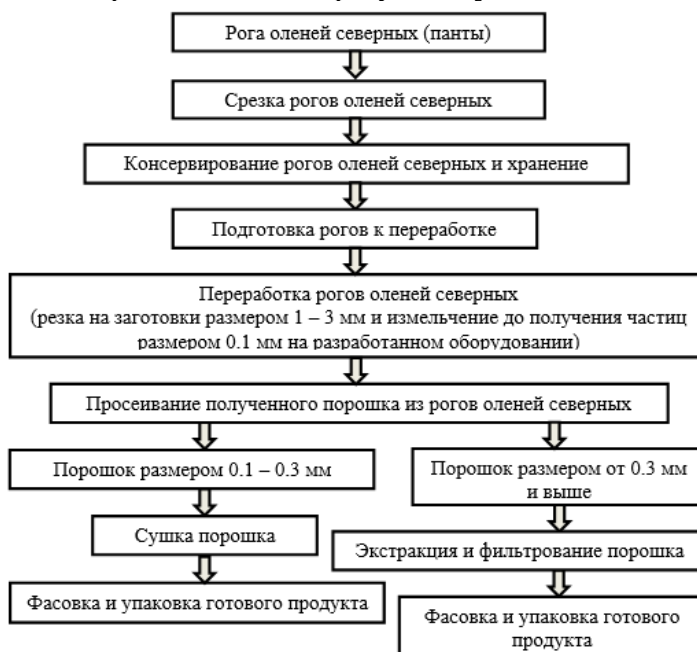
Рисунок 2 - Ресурсосберегающая технология переработки пантов оленей северных домашних
