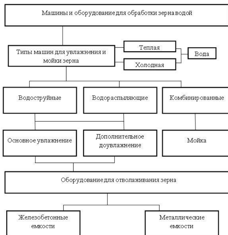
Рисунок 1. - Классификация машин и оборудования для обработки зерна водой.
