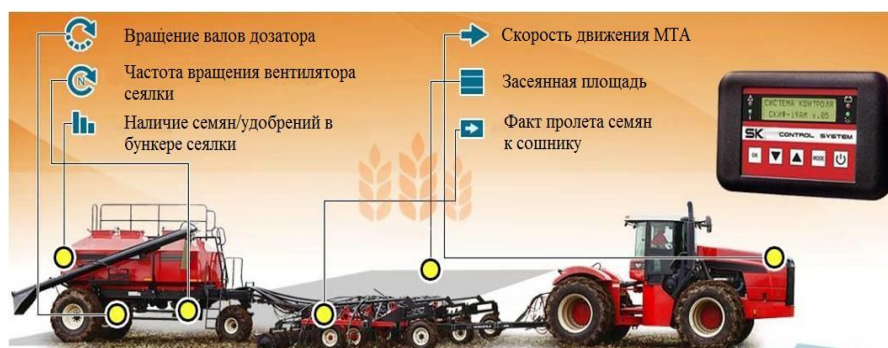
Рисунок - Система контроля «СКИФ»
