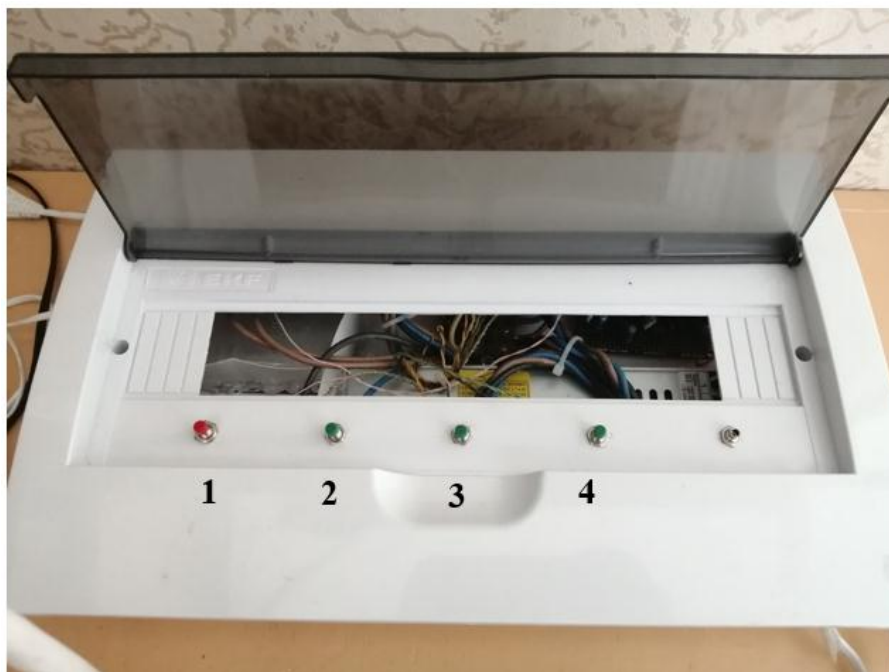
Рисунок 3 – Переключатель режимов и регулятор светового потока светодиодов
