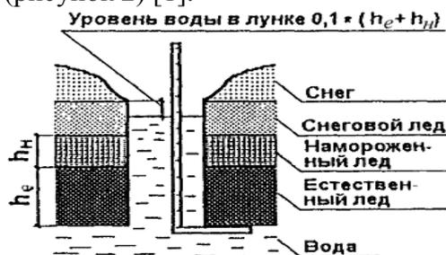
Рисунок 2 - Структура льда по ширине. Измерение толщины ледяного покрова градуированной рейкой
