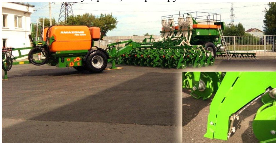
Рисунок 3 – Сеялка Primer DMC с долотовидными сошниками, оборудованными для внесения КАС
