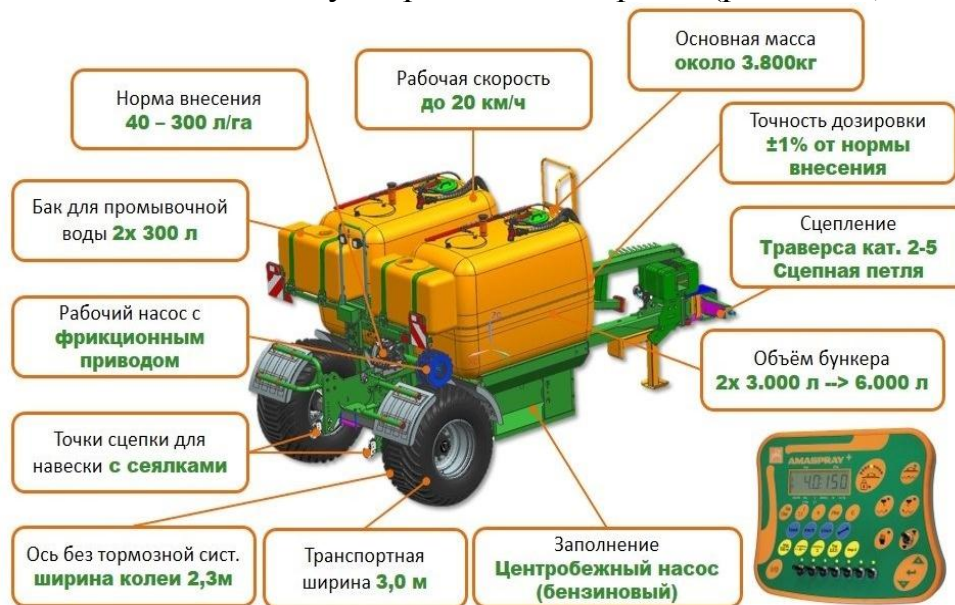
Рисунок 1 – Агрегат FDC - 6000 для перевозки и подачи КАС почвообрабатывающим агрегатам и сеялкам АО «Евротехника»
