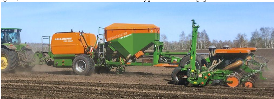
Рисунок 4 – Агрегат FDC-6000 с EDX 9000-ТС для посева подсолнечника и кукурузы одновременно с внесением жидких-КАС и твердых минеральных удобрений
