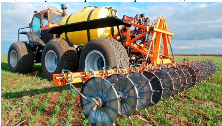
Рисунок 2 – Инновационный самоходный агрегат-мультиинжектор «Туман» ООО «Пегас-Агро» для внутрипочвенного внесения жидких удобрений
