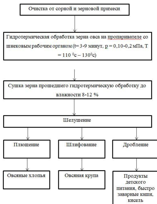
Рисунок 1 – Технологическая схема процесса комплексной переработки зерна овса
