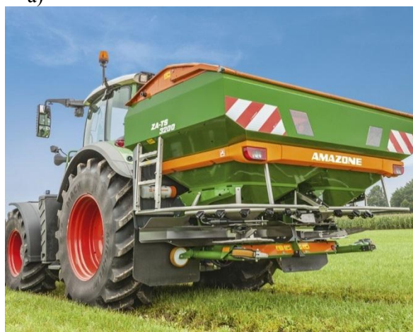
Рис.1.а)-б)-Опрыскиватель-«AMAZONEN-Werke» с удлинителями для обработки посевов жидкими минеральными удобрениями, в)-разбрасыватель для внесения твердых минеральных удобрений
