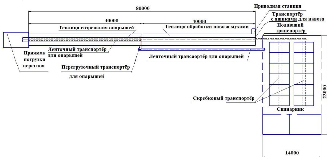
Рисунок 3 – Схема переработки навоза
