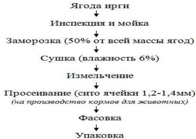
*Рисунок 1 – Блок схема получения порошка из ягод ирги*
