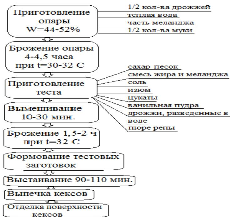
Рисунок 1 – Принципиальная схема производства кекса на биоразрыхлителях с внесением пюре репы
