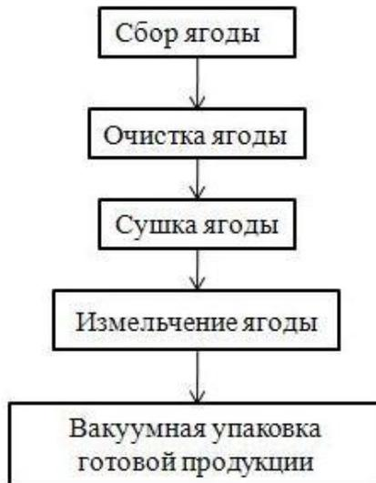
*Рисунок 1 – Технология получения сухих ультрадисперсных порошков*
