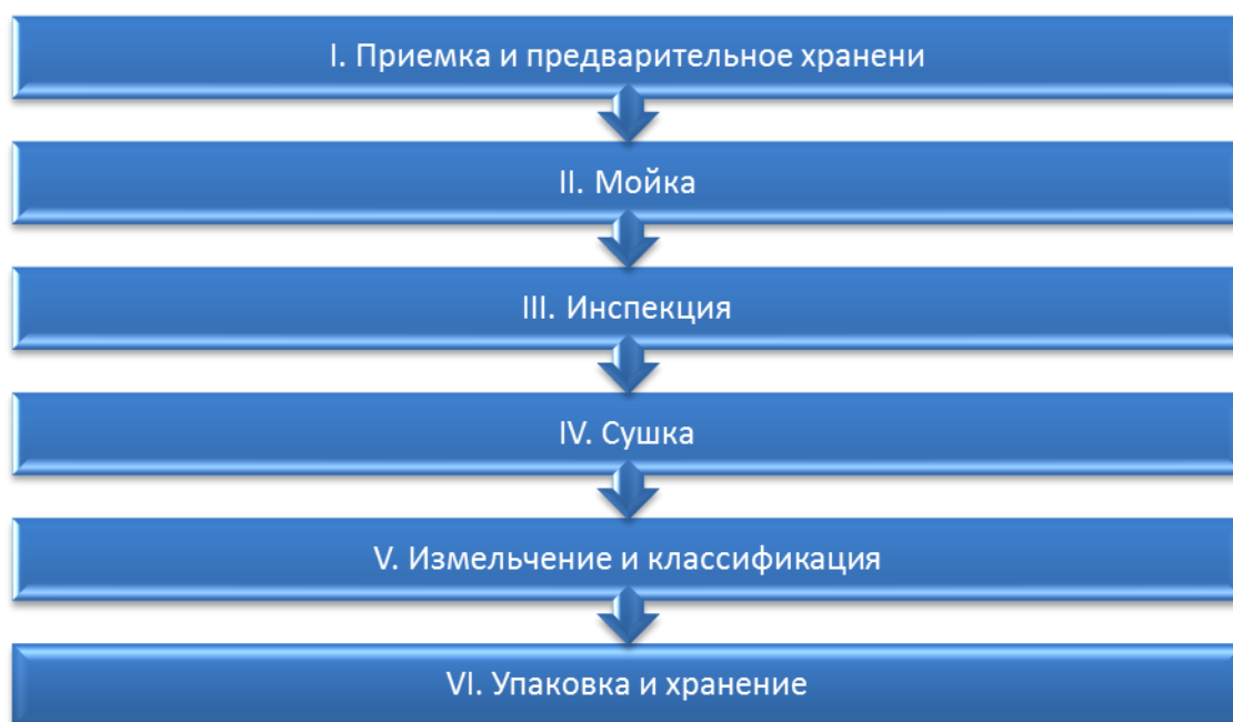
Рисунок 1 – Технологическая схема получения порошка из плодов черемухи
