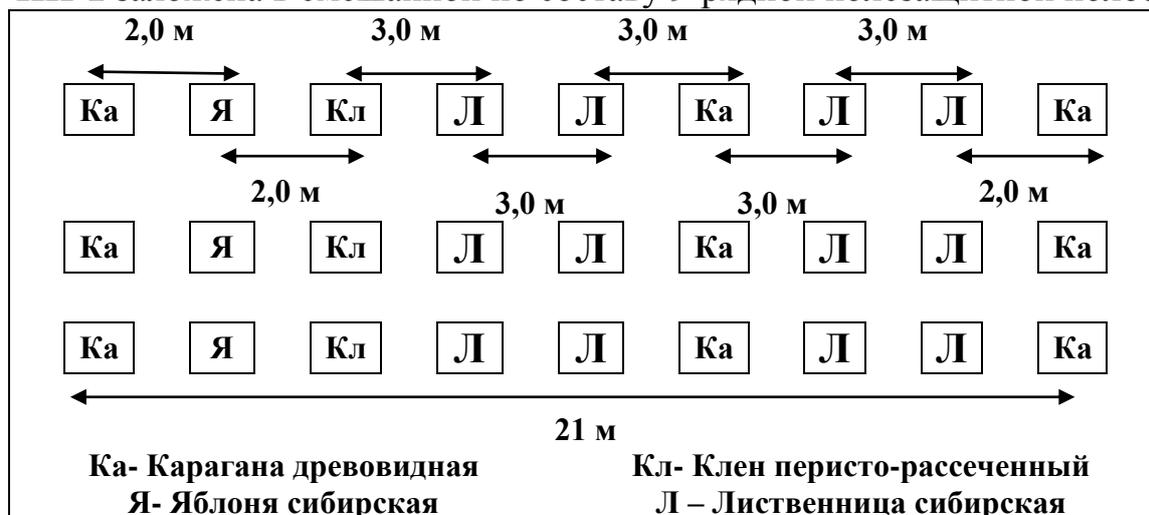
Рисунок 1 –Схема размещения деревьев и кустарников в лесной полосе на ПП 1
