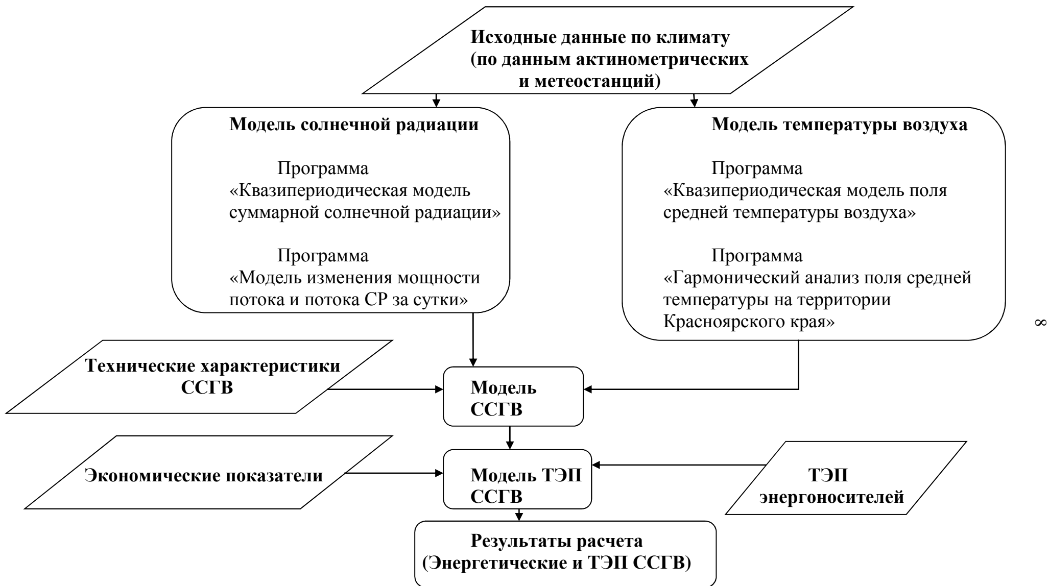
Рисунок 1 – Структура моделирования влияния природно-техногенных факторов на режимы работы, энергетическую и экономическую эффективность ССГВ
