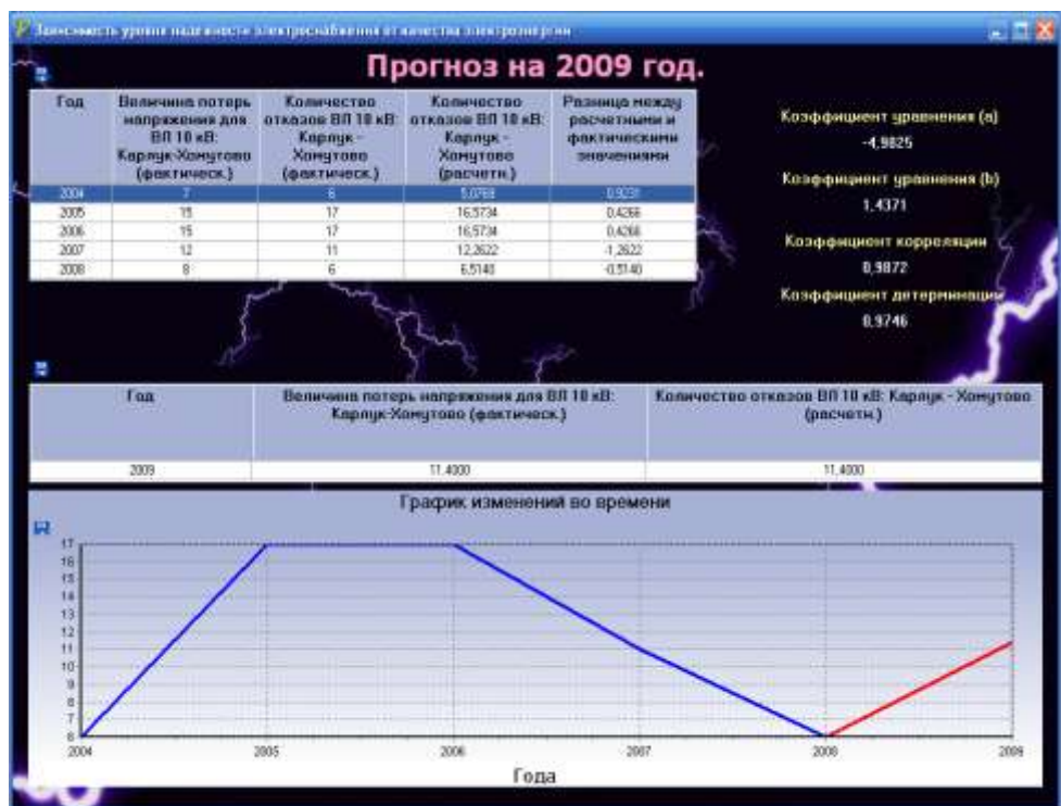
Рисунок 9 – Окно вывода результатов прогнозирования числа отказов, на основании информации о величине потерь напряжения в линии электропередачи
